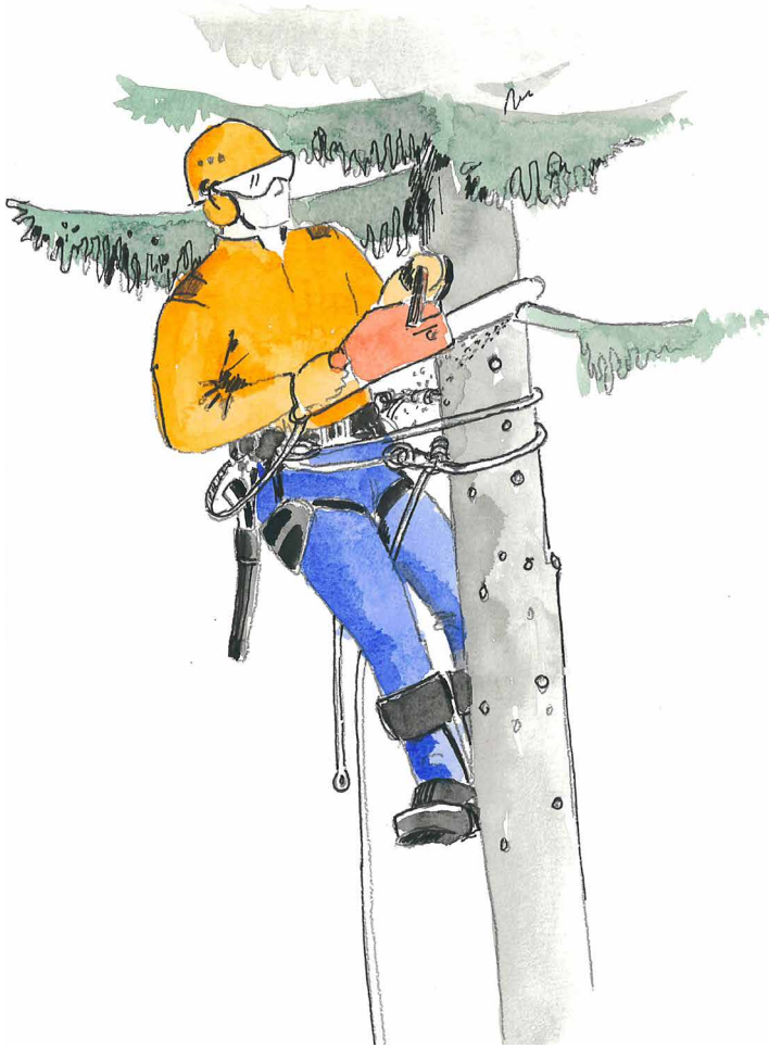
Kuva 9. Oksien poistamista ylöspäin kiivettäessä. Sahaamista hartialinjan yläpuolelta on vältettävä.
