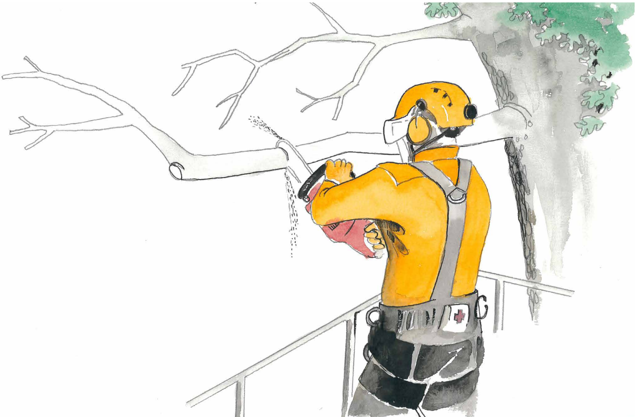
Kuva 15. Sahaus ja työjärjestys on suunniteltava niin, ettei puun massat osu koriin tai henkilönostimeen tai sen tukijalkoihin.
